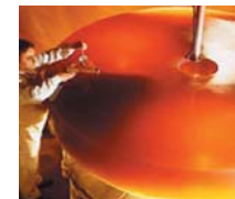
Schott 2.8-m Zerodur blank
